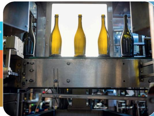
L'implementazione di un **sistema di ispezione automatizzato per le bottiglie vuote** per migliorare la qualità del prodotto finito riducendo i difetti e gli sprechi.
