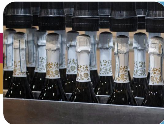
Installazione di un **sistema di controllo e allineamento delle capsule** finalizzato alla riduzione degli errori di confezionamento, e quindi degli scarti.
